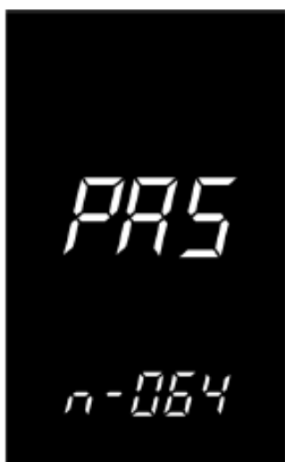
Interface de configuração dos parâmetros da relação do sensor PAS
