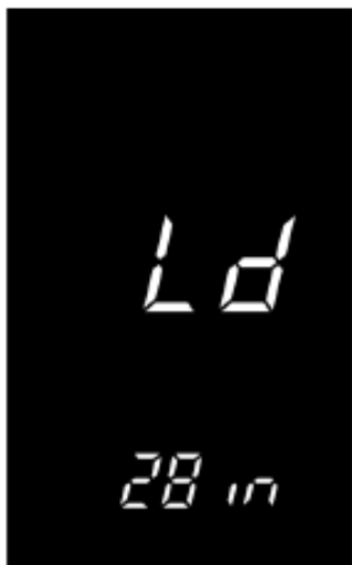
Interface de configuração do tamanho da roda
