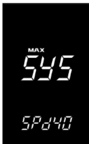
Interface de configuração do limite máximo de velocidade
