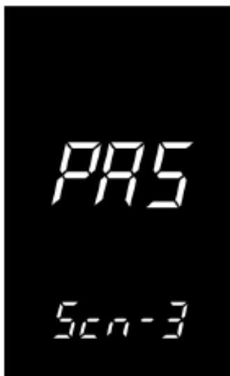
Interface de configuração de sensibilidade do sensor PAS
