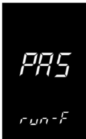
Interface de configuração da direção do sensor PAS
